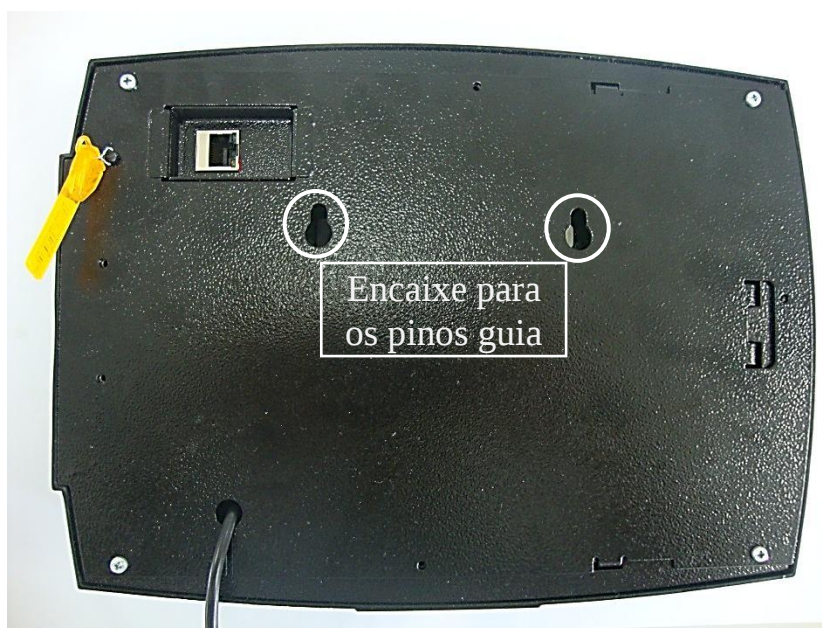
Figura 3 - Fundo do relógio com indicação dos encaixes dos pinos guia
